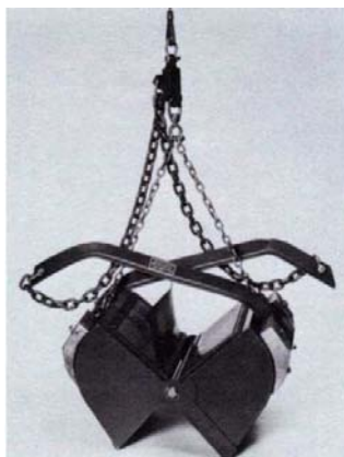
Figure 22. Benne Van veen (0,1 m 2 ) appropriée dans les sédiments vaseux peu profonds (Poids à vide 20 kg) (Source : Fiche technique REBENT)
