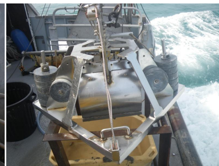
Débordement de la benne et descente jusqu'au fond où le godet récolte 0,1 m 2 de sédiments sur environ 30 cm
