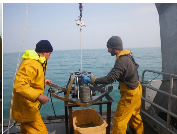
Remontée de la benne, retour à bord et récupération de l'intégralité du matériel échantillonné
