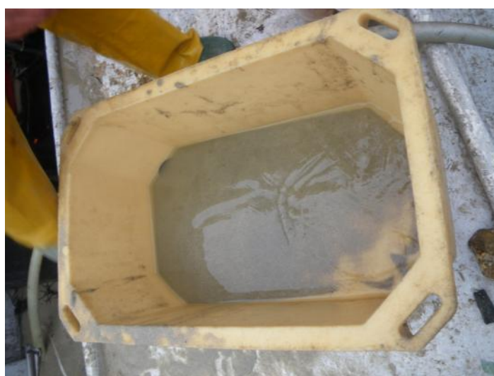
Tamisage du sédiment récolté sur maille carrée de 1 mm, fixation du refus de tamis dans l'alcool et numérotation des échantillons
