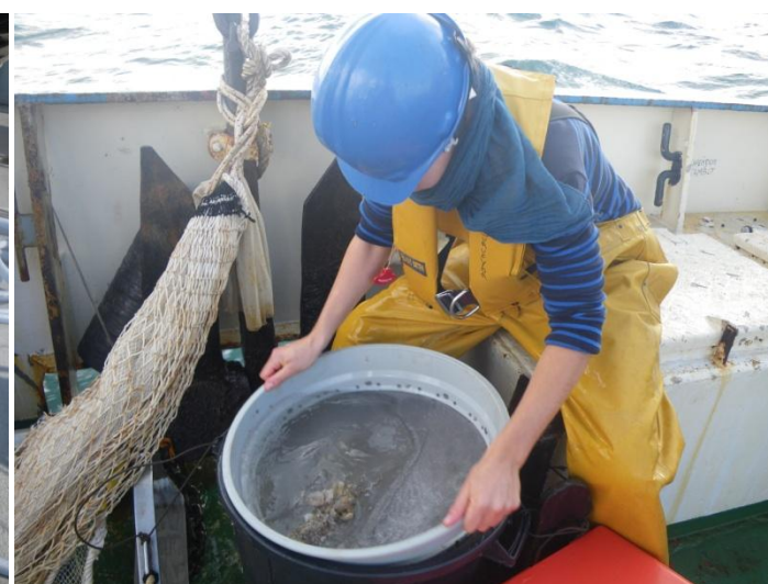
Tamisage du sédiment récolté sur maille carrée de 1 mm, fixation du refus de tamis dans l'alcool et numérotation des échantillons
