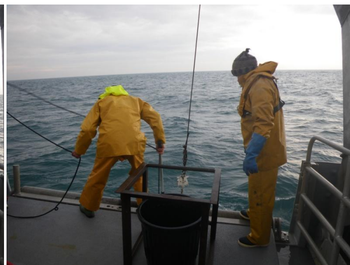
Débordement de la benne et descente jusqu'au fond où le godet récolte 0,1 m 2 de sédiments sur environ 30 cm
