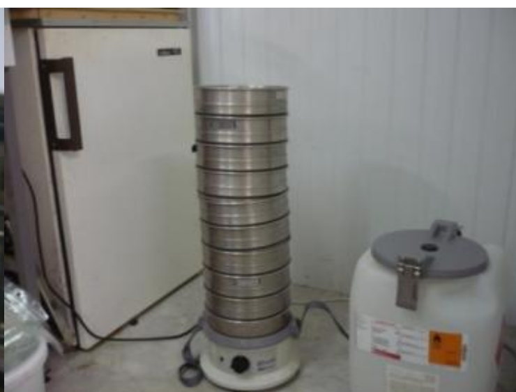
Analyse granulométrique : séchage des sédiments à l'étuve et tamisage sur colonne
