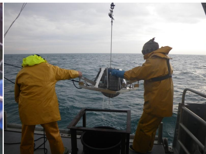
Débordement de la benne et descente jusqu'au fond où le godet récolte 0,1 m 2 de sédiments sur environ 30 cm
