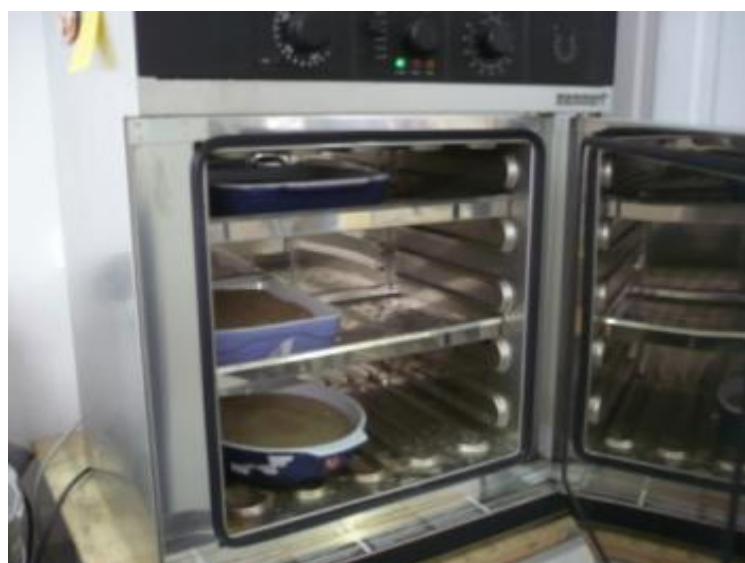
Analyse granulométrique : séchage des sédiments à l'étuve et tamisage sur colonne
