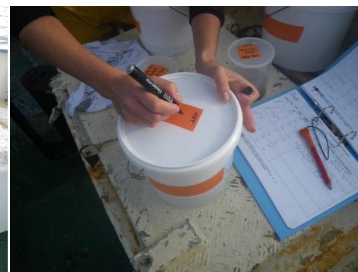
Tamisage du sédiment récolté sur maille carrée de 1 mm, fixation du refus de tamis dans l'alcool et numérotation des échantillons
