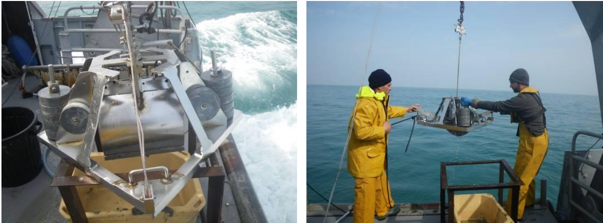
Figure 14 : Mobilisation de la benne Day-Grab
