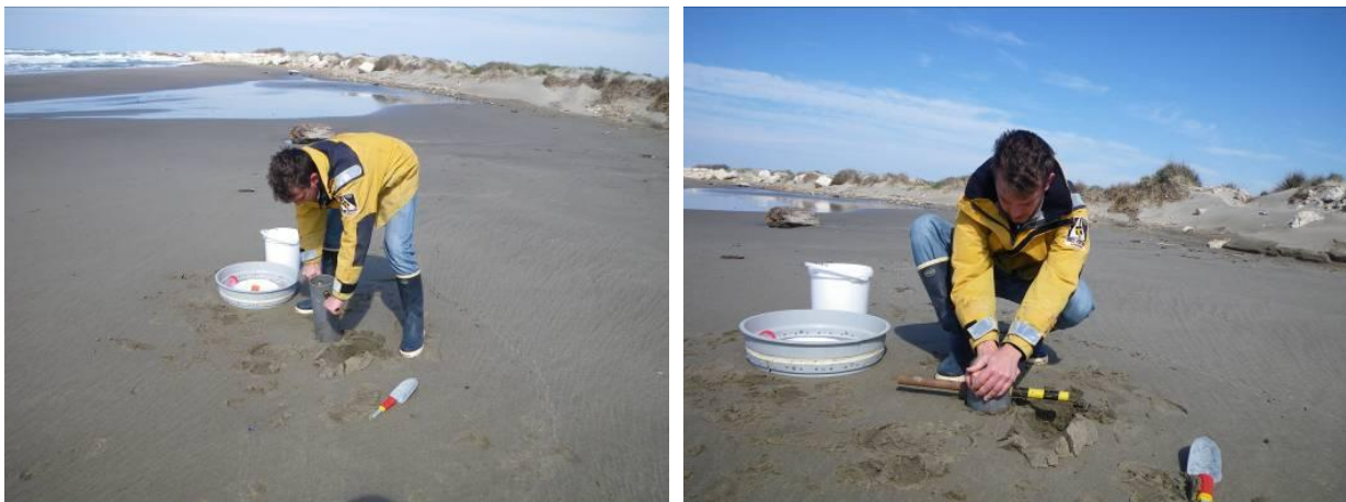
Figure 25 : Prélèvements de sédiment à l'aide d'un carottier à main
