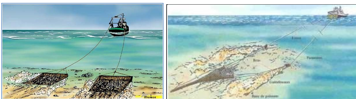
Figure 89 : Pêche à la drague (gauche) et au chalut de fond (droite) (Ifremer)
