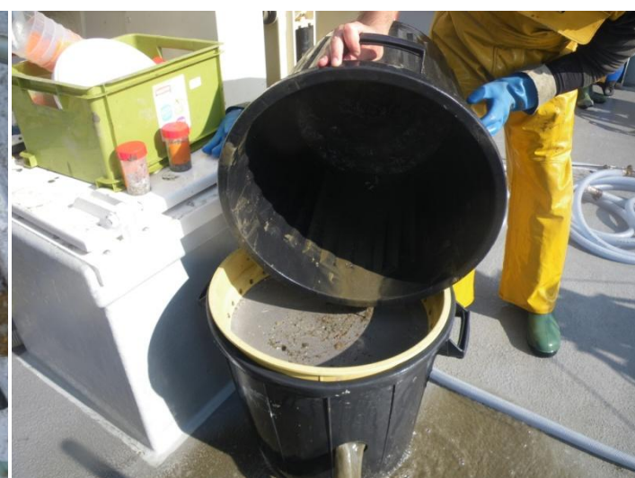
Tamisage du sédiment récolté sur maille carrée de 1 mm, fixation du refus de tamis dans l'alcool et numérotation des échantillons
