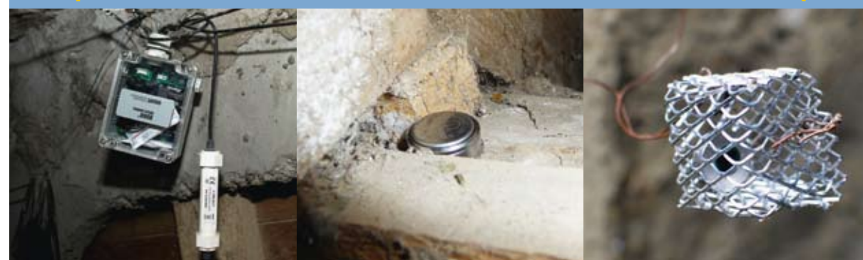
Photo 8 : Data-loggers utilisés pour caractériser les gîtes ( actions A2 et E4 ). Micro-station HOBO avec ses 4 sondes (à gauche), un Thermo-bouton en place (en milieu), et un Thermo-bouton dans une cage de protection afin de l'accrocher à un support et de limiter les pertes et vols (à droite).
