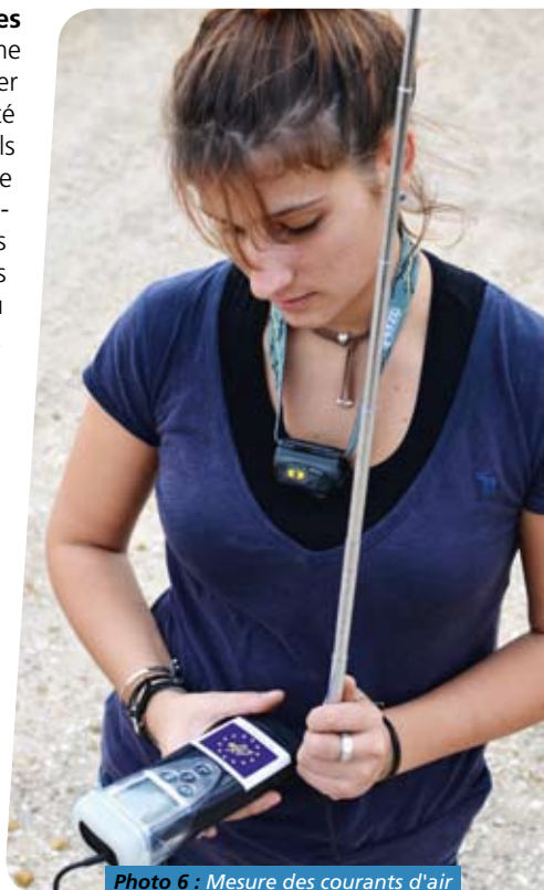
Photo 6 : Mesure des courants d'air avec un anémomètre.
