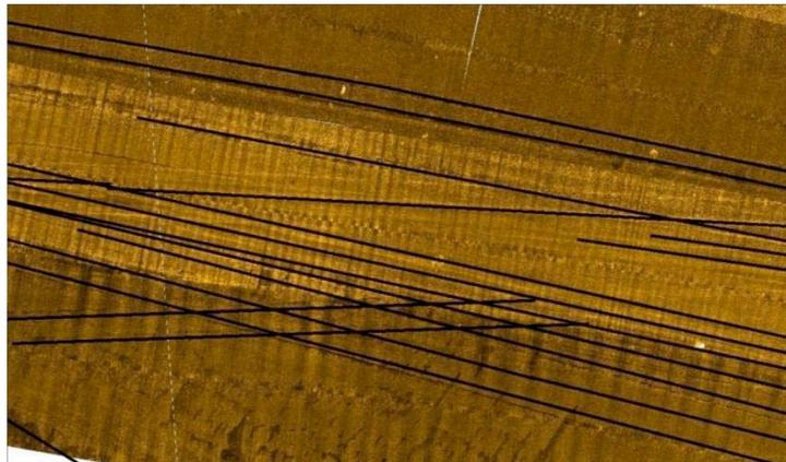
**Photo 31: Matérialisation des traces de chalutage sur image sonar (Andromède Océanologie)**
